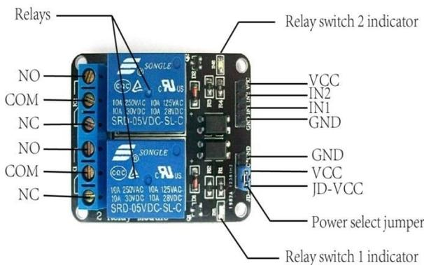
Fig 3.4 Relay module
